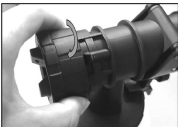
1. Páčka vzduchové krytky 2. Výčnělky na stříkací hlavě 3. Drážka na trysce 4. Tryska 5. Přední matice Čelní matice 7. Vzduchová hlavice 8. Drážka na čelní matici
