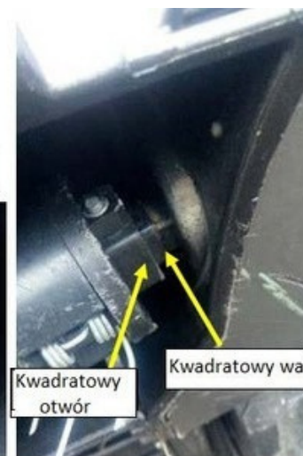
Rys. F-3 Umieścić kwadratowy koniec na wale
