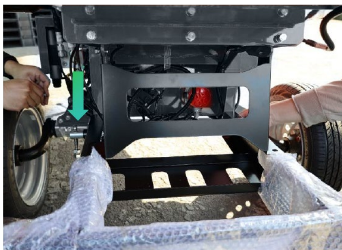
Wspornik sprężyny napinającej wskazany strzałką na powyższej ilustracji
