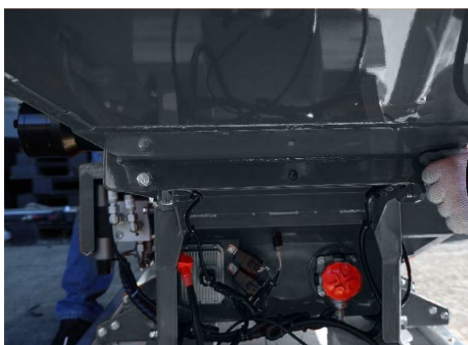
Zamontować trzy komplety śrub w dolnej części podajnika.
