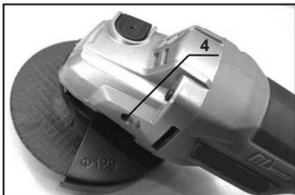
1) Boční rukojeť 2) Směr šroubování 3) Směr odšroubování 4) Místo upevnění boční rukojeti
