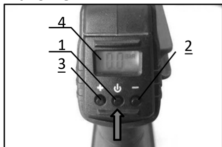
1) Tlačítko zapnutí/vypnutí LCD displeje/tlačítko změny jednotky 2) Tlačítko minus 3) Tlačítko plus 4) LCD displej
