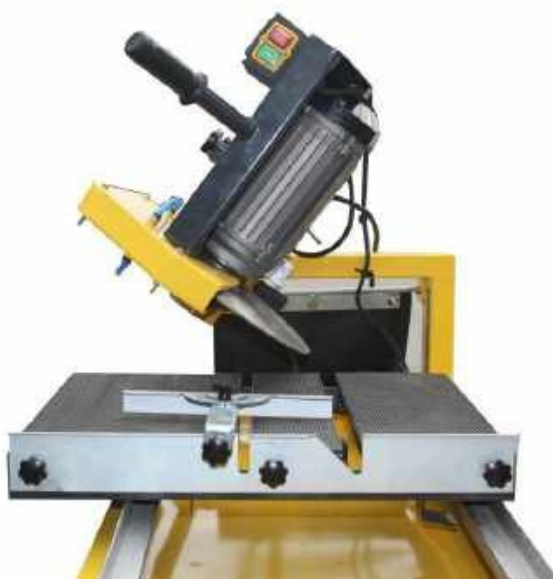
Pila při provádění pokosového řezu pod úhlem 45°
