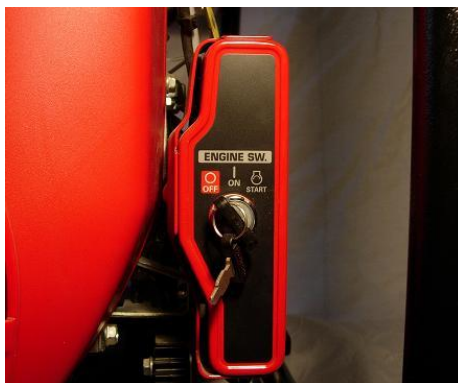
Vypínač motoru v poloze OFF (VYPNUTO) – pro modely SP4-12H, TP5-15H (s elektrostartem)
