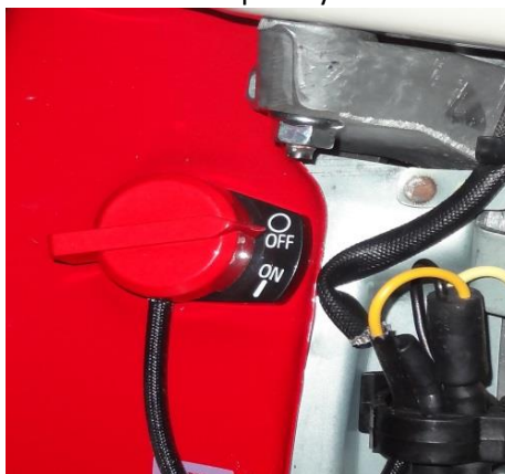
Vypínač motoru v poloze OFF (VYPNUTO) – pro modely SP2-6H, TP5-7H
