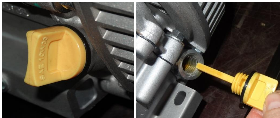
Kontrola množství oleje – pro modely SP2-4H a TP5-7H
