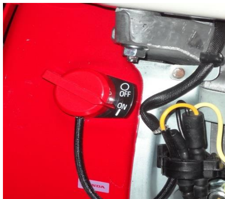
Vypínač motoru v poloze ON (ZAPNUTO) – pro mpodely SP2-6H, TP5-7H
