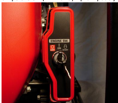
Vypínač motoru v poloze ON (ZAPNUTO) – pro mpodely SP4-12H, TP5-15H (s elektrostartem)
